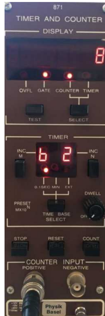
Abbildung 1.6: Der Zähler befindet sich im Rack der Hochspannungsversorgung und dem Verstärker (englisch amplifier). In der Mitte des Zählers kann eine Messdauer voreingestellt werden, während der dann die Ereignisse gezählt werden.
