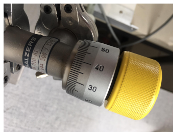
Abbildung 1.11: Wichtig: Ein Nadelventil darf nicht wie ein Wasserhahn bis zum Anschlag zuge dreht werden! Sobald ein «leeres Drehen» mit kaum Widerstand spürbar ist und der Druck auf dem digitalen Manometer konstant bleibt, ist das Nadelventil geschlossen. Weiteres Drehen kann das Nadelventil zerstören.
