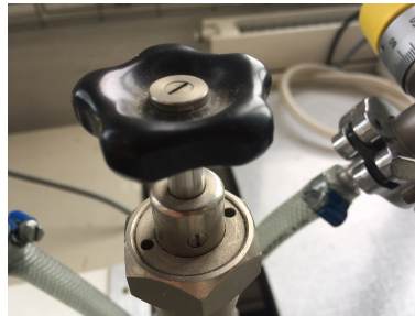
Abbildung 1.9: Das schwarze Ventil zum Belüften der Vakuumpumpe ist hier zu sehen. Die Pumpe ist immer nach Gebrauch direkt zu entlüften, da sonst Öl angesogen werden kann.
